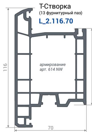
\* вариант установки армирования со стороны замка
